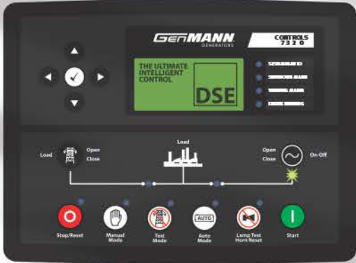
DSE7320 Módulo de control de arranque automático, con acceso remoto a través de una PC y envío de alertas vía mensajes de texto (SMS) con modem externo.
